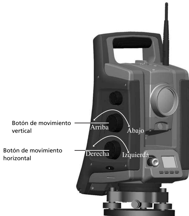
Figura 6.7 Botones de movimiento StepDrive para el posicionamiento
