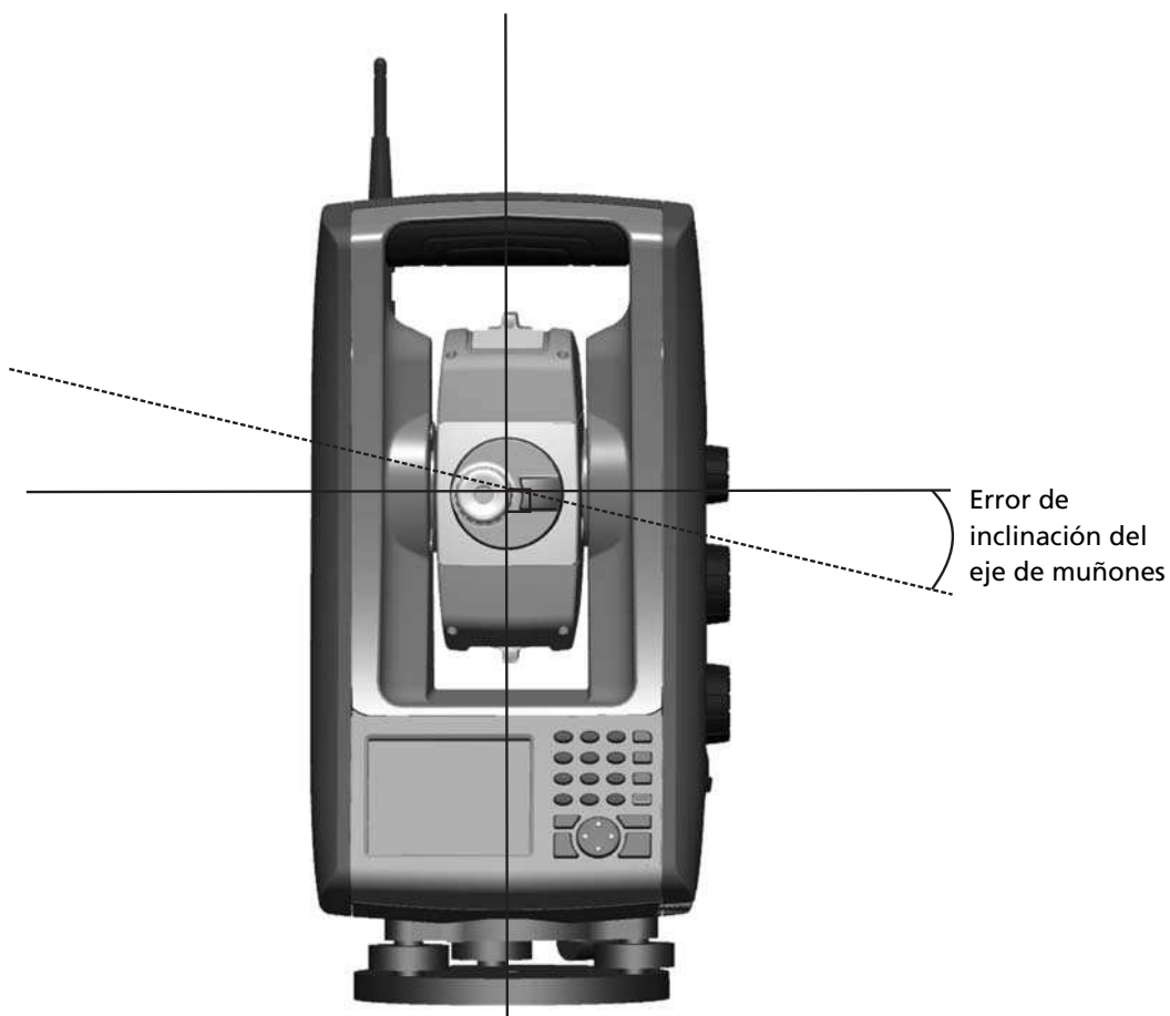
Figura 6.1 Error de inclinación del eje de muñones
