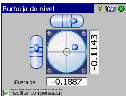
Figura 4.6 Burbuja electrónica para el proceso de nivelación
