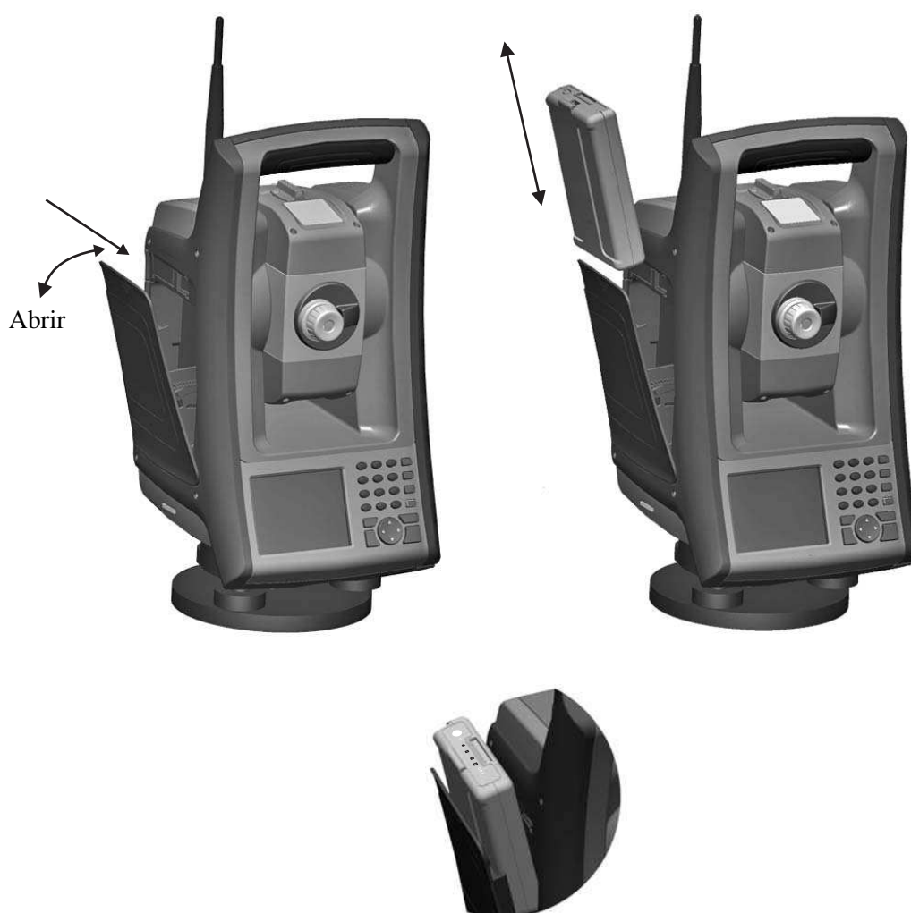
Figura 3.3 Cómo sacar y cambiar la batería interna
