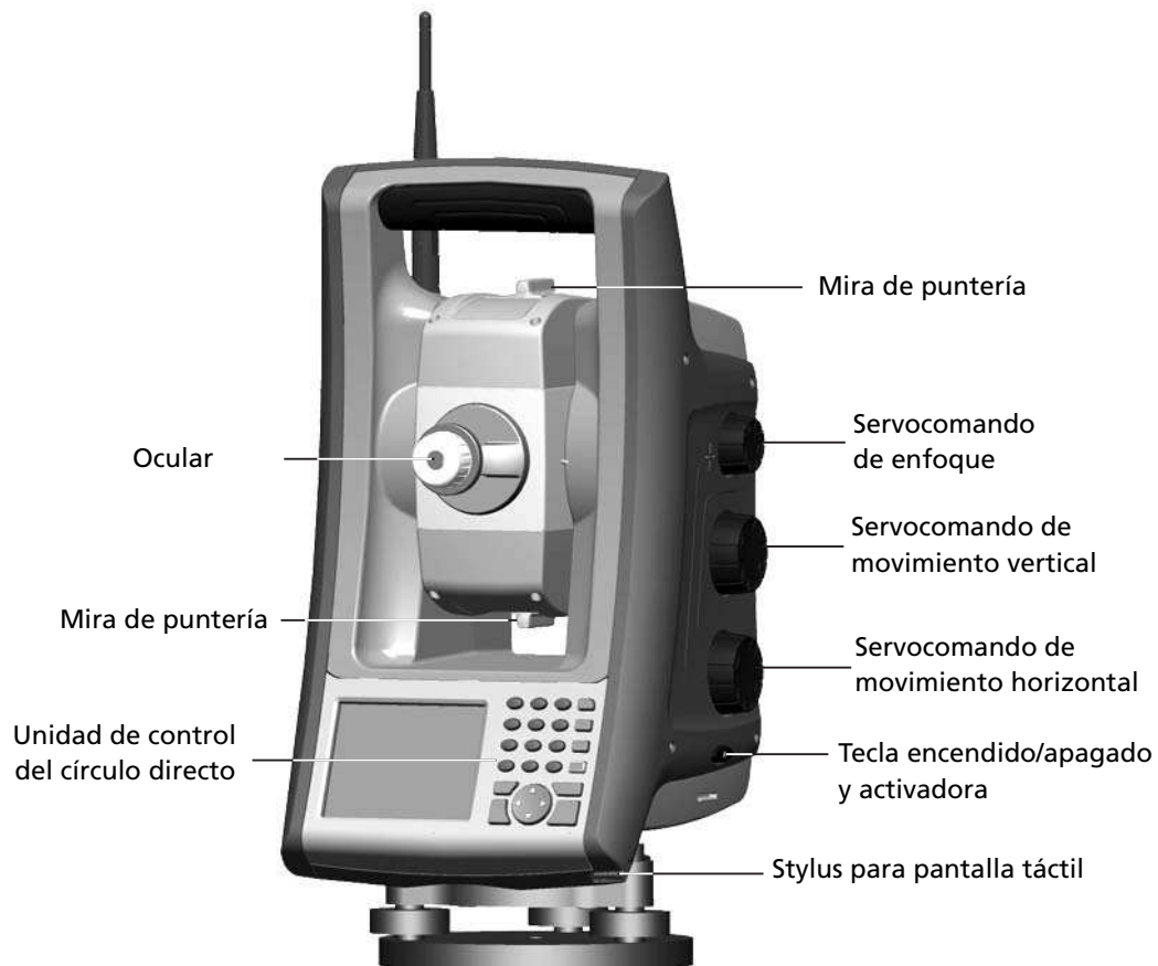
Figura 3.4 Vista del operador de la estación total Spectra Precision FOCUS 30
