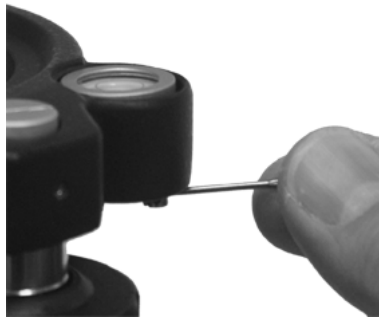
Figura 4.51 Ajuste del nivel esférico
